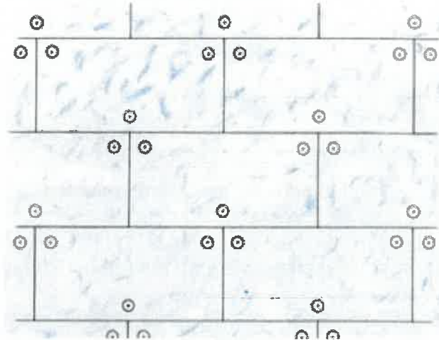
Fig. 16 Dublură cu 3 dubluri/placă
