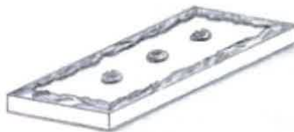
Fig. 8 Metoda de lipire pe contur
