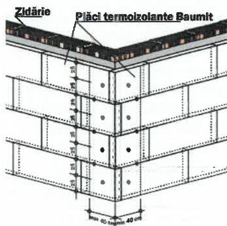
Fig. 13 Dispunerea plăcilor în câmp și la colțuri
