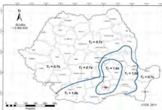
Zonarea teritoriului României în termeni de perioada de control (colț), T_c a spectrului de răspuns, conform P100-1/2013
