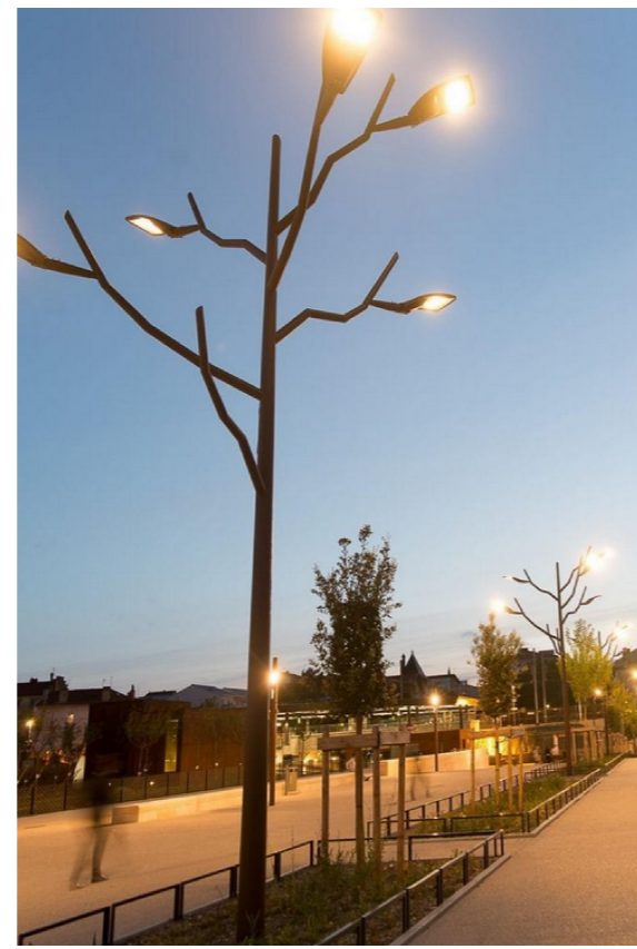
Corp de iluminat ornamental - confecție metalică, confecționat din lemn și vopsit cu 5 corpuri de iluminat stradale KYRO+1 SR/075 3105293 36W, 4799lm, 133 lm/W, 3000°K
