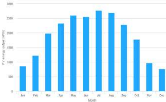
Figura 3. Performanța relativă a sistemului de panouri fotovoltaice pe an
