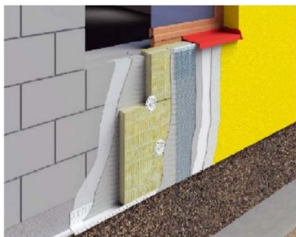
Termoizolare elevatie pereti
