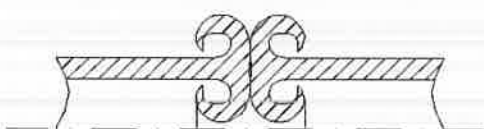
b. Sudura gresita - presiune de sudare prea mare
