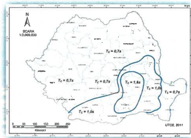
Fig. 6. Zonarea teritoriului in termeni de perioada de control (colt), T_c , a spectrului de raspuns
