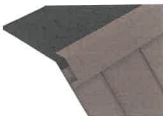
fig.43 Montajul șorțului pentru ruperea de pantă
