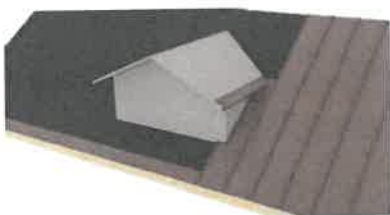
fig.54 Montajul șorțului de streășină pe lucrană
