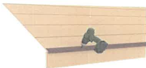
Fig.2 Montajul șorțului picurător sub folia anticondens
