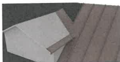
fig.58 Montajul panourilor în zona de dolie
