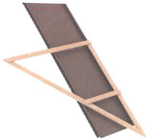
fig.27 Trasarea cu echerul de lemn
