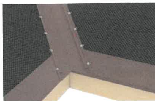
fig.25 Exemplu de dolie montată corect
