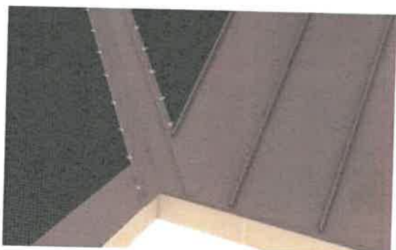
fig.29 Poziția finală a primului panou în zona doliei
