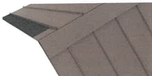
fig.46 Exemplu montaj final al șorțului pentru ruperea de pantă
