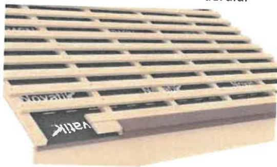
Fig.4 Montajul șorțului de streșină pe scândurile suport
