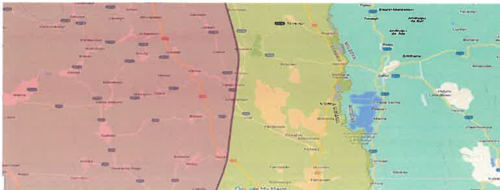
Figura 2.1.1. Zonarea valorii de vârf a accelerației terenului pentru proiectare cutremure având IMR 225 de ani și probabilitate de depășire de 20% în 50 de ani
