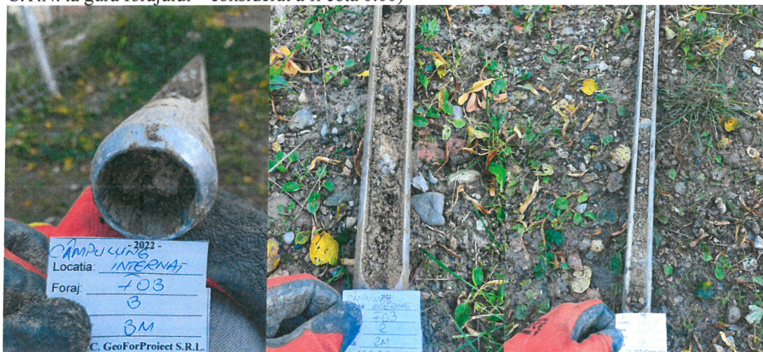
Fig 6.4.1. Imagini generale cu prelevare probelor tulburate și netulburate – Forajul F01
