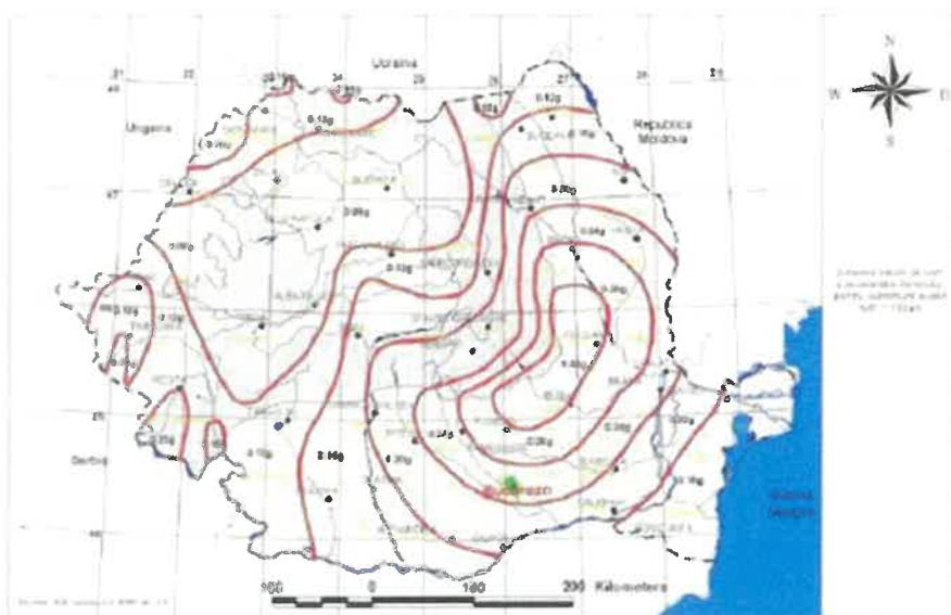
Zonarea valorilor de vârf ale accelerației terenului pentru proiectare ag cu IMR = 100 ani
