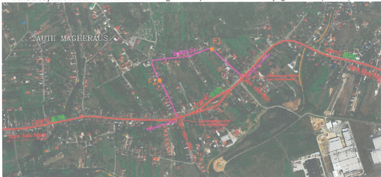
Fig. 6 Plan de amplasare a forajelor geotehnice efectuate
