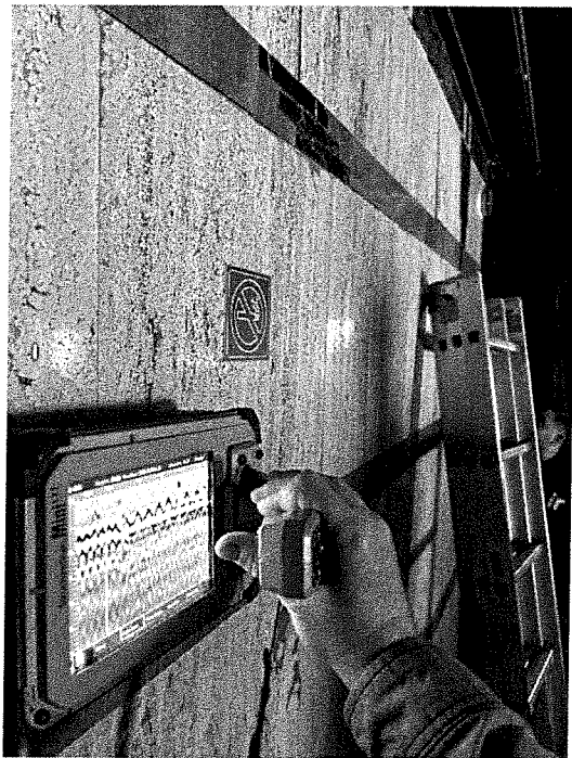
15) RADAR PERETE PER 1-2 BETON -PLASA BARE /10 /20 CM
