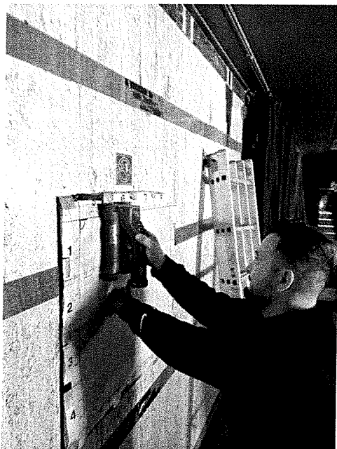
16) PAH PERETE PER 1-2 BETON -PLASA BARE VERT 10-12MM /20 CM +ORIZ 8MM /10 CM
