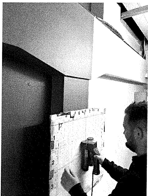
28) PAHOM ST 1-POD LAT 1 30 CM -2 BARE 20 MM +ETR 8 MM /25 CM
