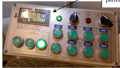
Panou de operare: Controlul debitului de degivrare Controlul amestecului A se vedea pagina 20.
