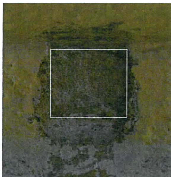
Fig.32. Test de curățire ancadrament (stânga)/ Test de curățire capac contrafort (dreapta)
